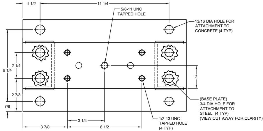
**MODEL M2S-1E SEISMICALLY RESTRAINED VIBRATION ISOLATOR FOR 1" DEFLECTION**
